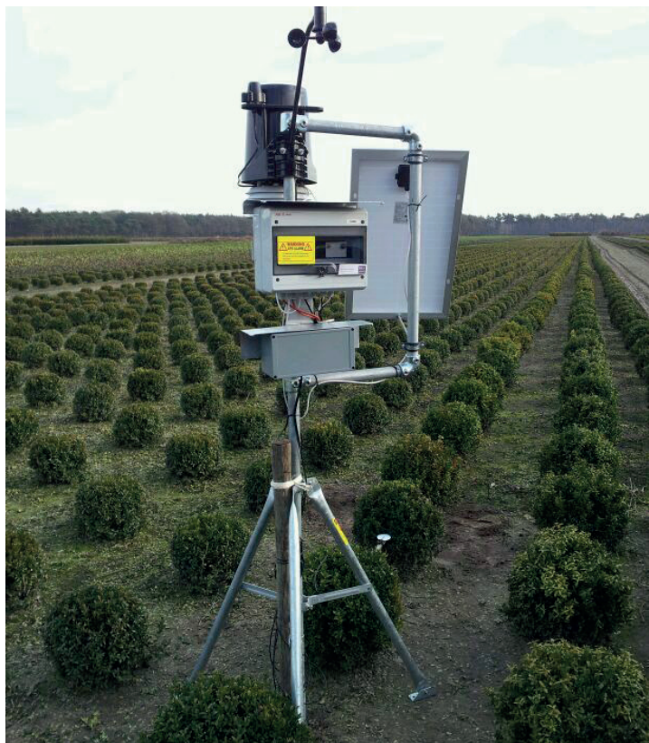
Een weerpaal meet de weersomstandigheden (o.a. temperatuur, luchtvochtigheid en windsnelheid) op het perceel of tussen het gewas.
