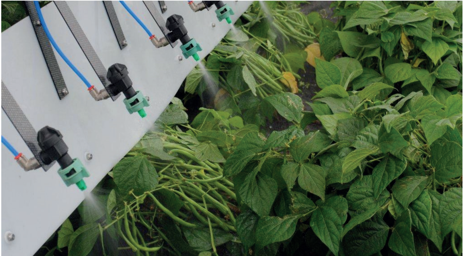
Met deze Wingssprayer is, net als bij alle veldspuiten met aanvullende driftreducerende voorziening, een druklogger niet verplicht.
