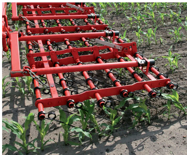
De veertandeg gaat onkruid te lijf met zijn lange, dunne en flexibele veertanden.
