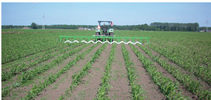
Gewasgeleide schoffels worden gestuurd door de gewasrij. Dit kan zelfs in kleine, tere gewassen, mits de gewasrij vrij recht is.
