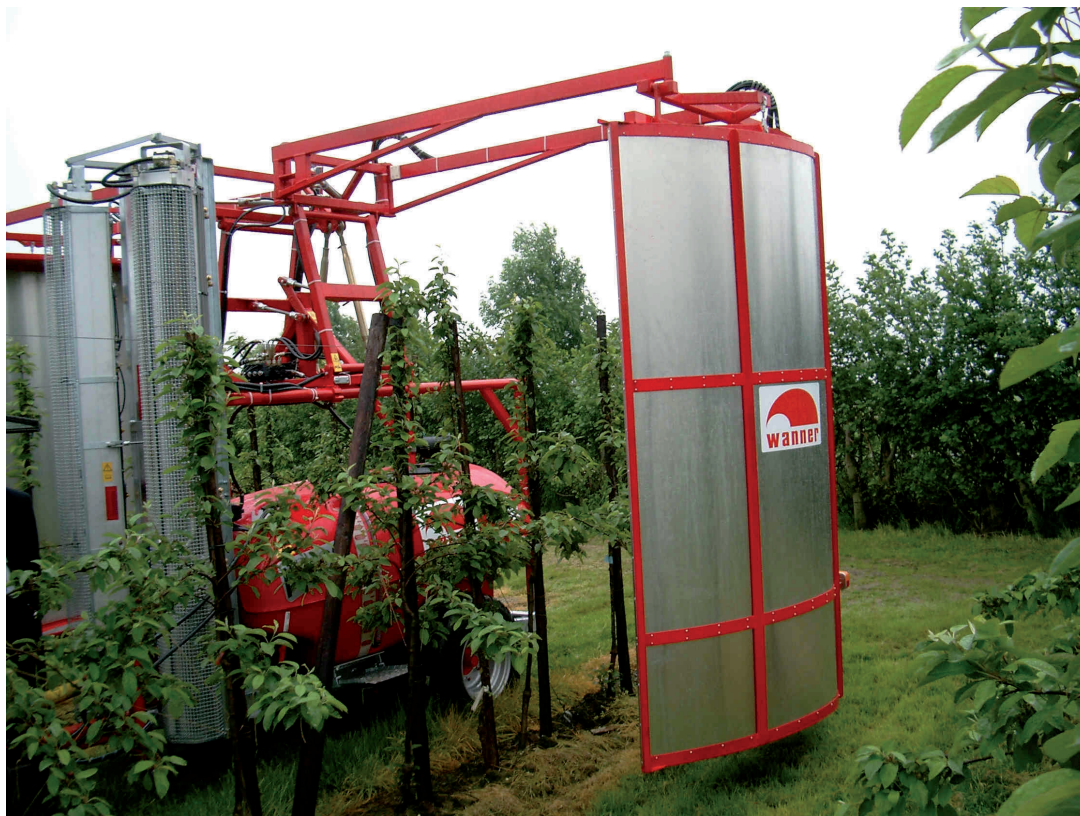
De Wannerspuit wint met de reflectieschermen 25 tot 30% spuitvloeistof terug. De reflectieschermen geven, in combinatie met ten minste 75% driftreducerende doppen een driftreductie van minimaal 95%.
