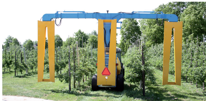
VLOS zorgt door de variabele luchtuitgift naar links en rechts voor minimaal 95% driftvermindering bij gebruik van ten minste 90% driftreducerende doppen.
