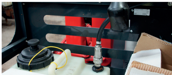
Met middelinjectie kunt u op een deel van het perceel een extra middel toevoegen aan de spuitvloeistof. Een volveldse bespuiting met dat middel is dan niet nodig.
