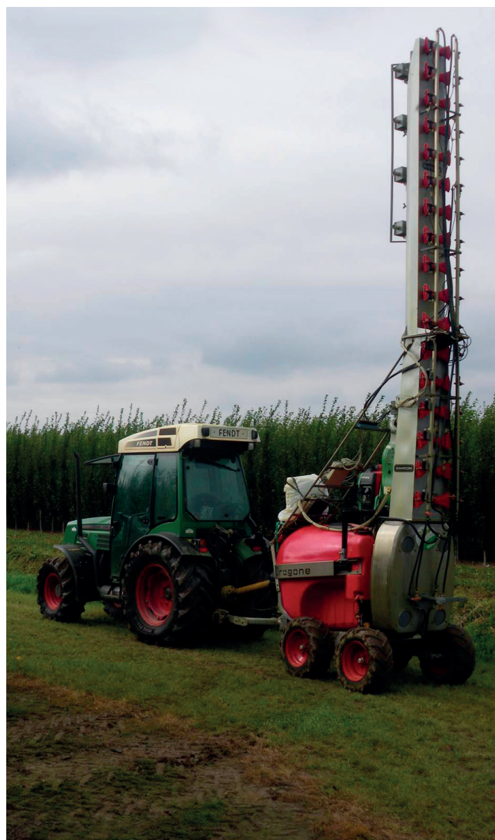
De mastspuit bereikt d.m.v. venturidoppen en sensoren een driftreductie van 96%, en heeft een bereik tot 6 meter hoogte.
