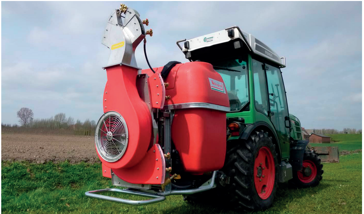
Door de gerichte bespuiting van de blaasmonden reduceert de Dragone TAV spuit de drift en komt tot 5 meter hoogte. Bron: Damcon
