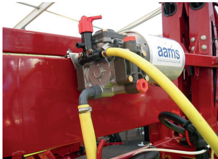
Continue reiniging werkt door middel van verdringing (i.p.v. verdunning), waardoor de spuit in korte tijd met minder water grondig gereinigd wordt.
