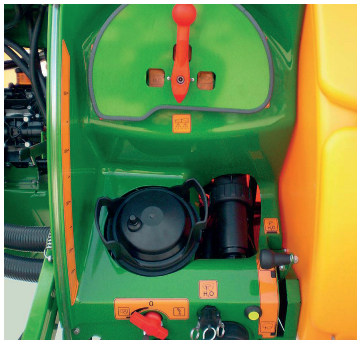
Met automatische interne reiniging kunt u makkelijk en veilig de spuit inwendig reinigen.
