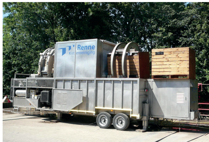
Een gesloten kistenwasser kan door desinfectie het water hergebruiken. Hierdoor is de hoeveelheid te verwerken waswater veel kleiner.
